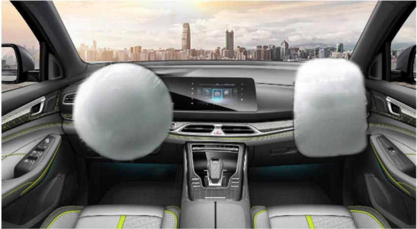
Ilustracija aktiviranja glavnog i suvozačevog vazdušnog jastuka
